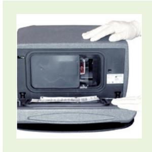
2. Einlegen des FastPack® IP-Beutels in den Analyzer
