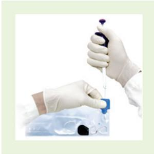
1. Einfüllen der Probe in den FastPack® IP-Beutel
